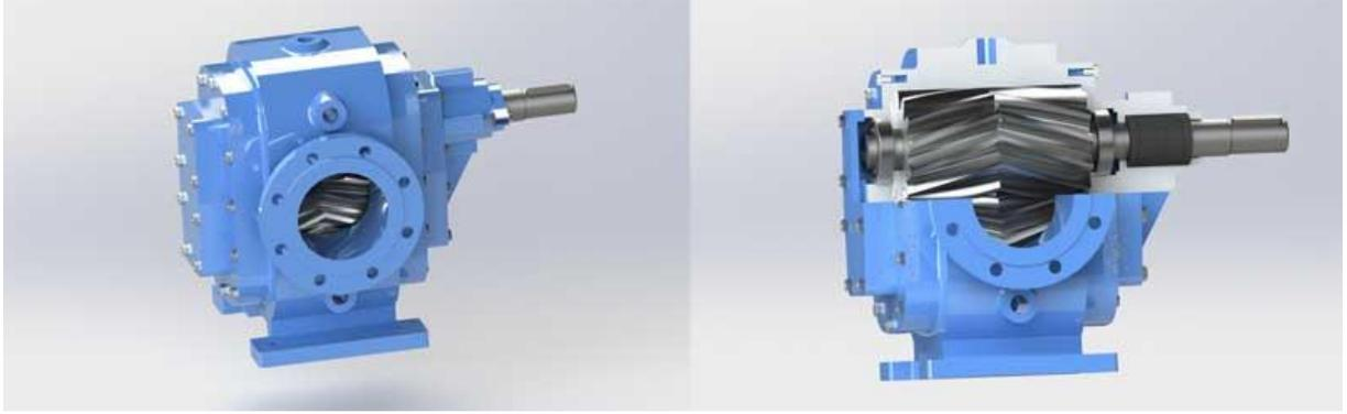
Dişli Pompalarda birbiri ile çalışan iki dişli, bir gövde içerisine monte edilir. Tahrik miline bağlanan dişli, avare dişliye hareket verir. Gövdenin küçük toleranslarında birbiri ile çalışan dişlilerin hareketi sonucu meydana gelen vakum, akışkanı pompa içerisine doğru taşır. Dişli boşluklarına dolan akışkan, dişlilerin birbiri ile yaptığı kaymalı yuvarlanma hareketi ile meydana gelen basınç altında pompa çıkışına doğru ilerler. Dişli pompalar her iki yönde çalışabilirler.
